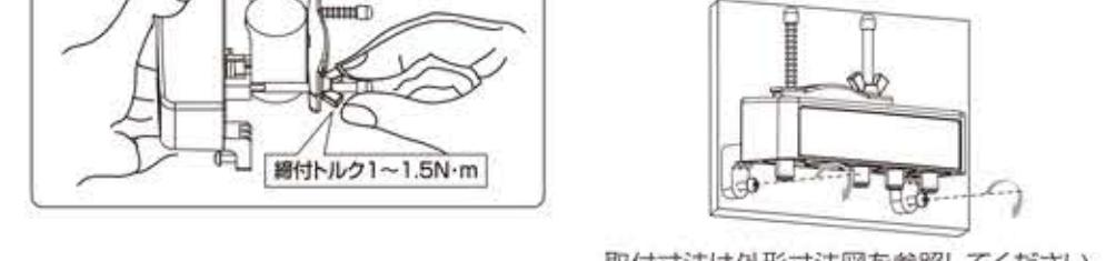
取付寸法は外形寸法図を参照してください
