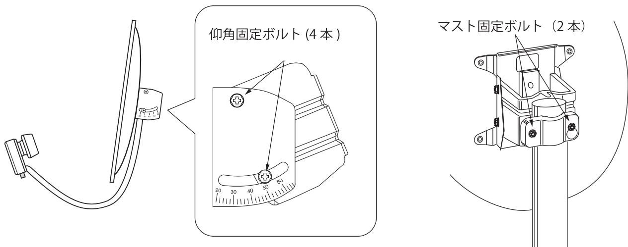
**△注意** アンテナは、強風の影響を受けやすいため、各固定ボルトは、しっかり締め付けてください。
