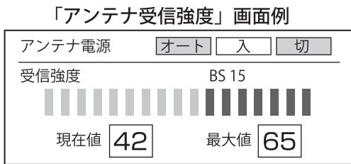
アンテナ受信強度の値は、10秒程遅れて画面表示が変わります。1°位、動かしては止め、「アンテナ受信強度」の値を確認しながら調整を行ってください。
